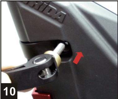
シートモールディングのフック部にQ/Rクランプのヒンジ部をはめ込んでから左側からQ/RクランプとQ/Rレバーを取り付けて下さい。(左側は大の穴)
