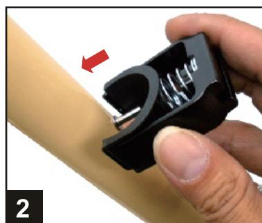
Q/Rロッキングマウントをシートピンに挿入してリアチューブに、はめ込んで下さい。
