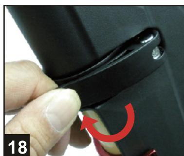
Q/Rレバーが適正に調整されていることをご確認下さい確実に固定されていることを確認して下さい。
