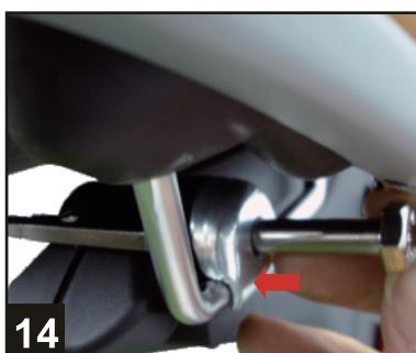
シートモールディングの右側からサドル固定ボルトを固定金具を介して入れて下さい。
