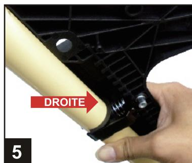
右側のシートモールディングを取り付けますQ/Rロッキングマウントのはめ込み位置はシートモールディングの中央部分が標準です。
