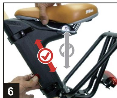
Q/Rシートモールディングの高さを調整してください(リアチューブにすべらすように)。
