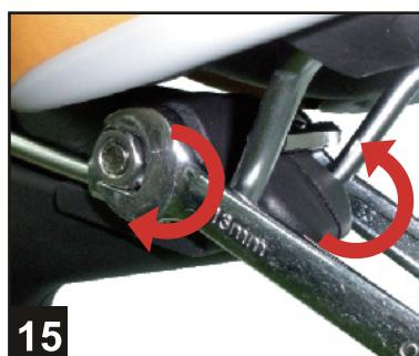
13mmのスパナでナットを締付けて下さい締め過ぎないように注意して下さい。
