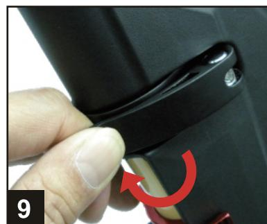
Q/Rシートモールディングの高さ調整後は、Q/Rレバーが確実にロックされていることをご確認下さい。
